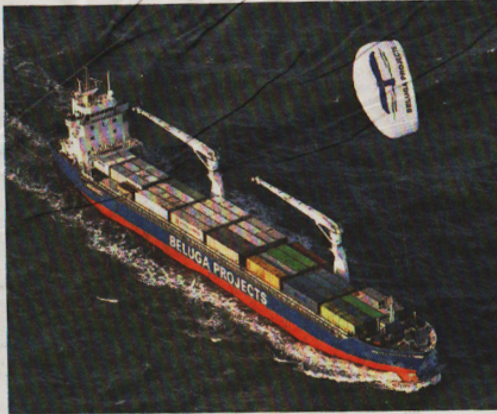
Le cargo tiré par une aile de kite fait partie des pistes de réflexion pour sortir le transport maritime de l'ère des énergies fossiles.
